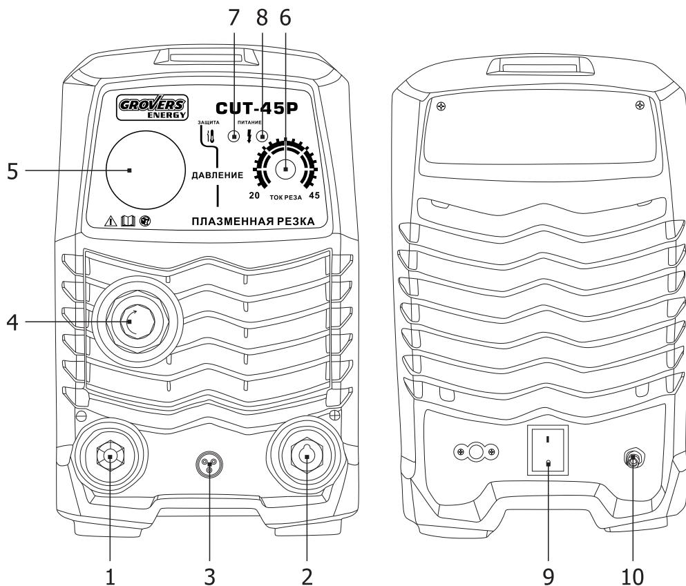
1. **Разъём для подсоединения плазмотрона**
